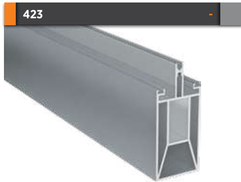
423 Destekli Orta Kayıt Profili Reinforced Center Mullion Profile Paket İçi Adet Amount within package 1 Gramajı Weight 3,142 kg/m
